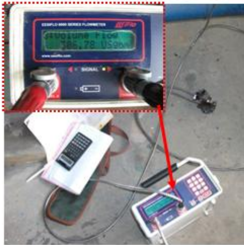
รูปที่ 6.56 การตรวจวัดเครื่องทำน้ำเย็น
