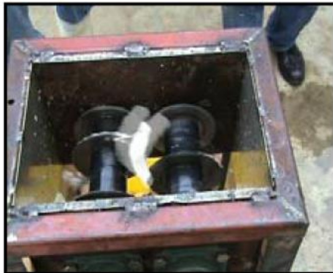
รูปที่ 6.14 ต้นแบบเครื่องสับที่ทดลองดำเนินการ
