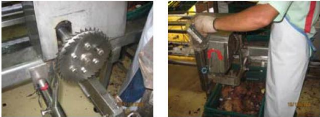
รูปที่ 6.13 การเปลี่ยนเฟืองกระเทาะกะลาเพื่อให้สามารถเปิดกันกะลาและกระเทาะในเครื่องเดียวกัน
