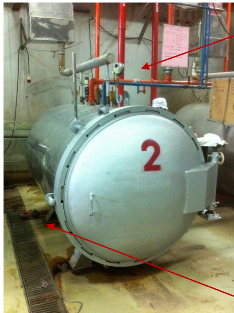
รูปที่ 5.8 แสดงการสูญเสียพลังงานความร้อนของหม้อฆ่าเชื้อ (Retort)
