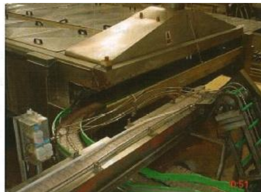
รูปที่ 6.5 สายพานลำเลียงในกระบวนการผลิตภายหลังดำเนินการปรับปรุง ทำให้เครื่อง Cooker สามารถรับผลิตภัณฑ์ได้ 2 สายพานการผลิต
