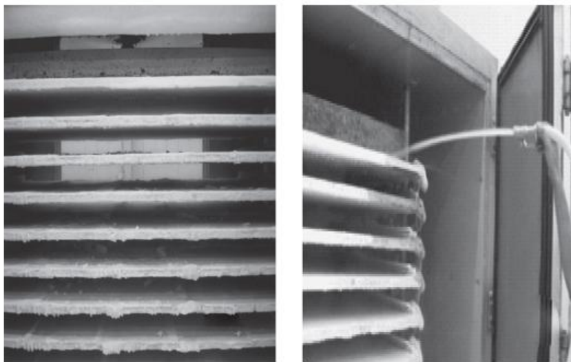
รูปที่ 6.38 ลักษณะน้ำแข็งในตู้แช่เยือกแข็งแบบ Contact plate freezer (ซ้าย) และการล้างโดยท่อปลายเปิด (ขวา)
