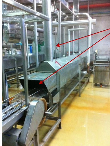
รูปที่ 5.7 แสดงการสูญเสียพลังงานความร้อนของเครื่องไล่อากาศ
